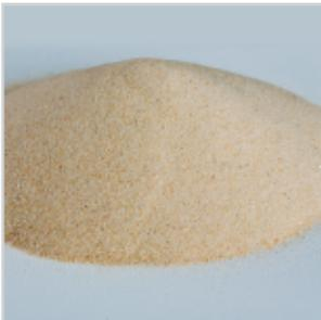
Современная технология засыпки предохранителей наполнителем (кварцевый песок высокой очистки) позволяет достичь высокой плотности заполнения, что обеспечивает эффективное гашение электрической дуги внутри предохранителя при его срабатывании.
