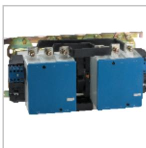
Высокая жесткость конструкции и уменьшение ошибок монтажа для контакторов на номинальные токи свыше 100 А обеспечивается за счет наличия заводского соединения в главной цепи, установки контакторов на двух металлических рейках и механической блокировки.
