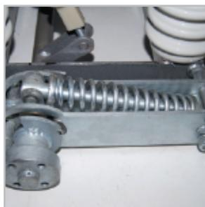
Вид привода: пружинный, взводимый вручную или электроприводом.
