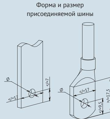
Присоединение кабелем без кабельного наконечника
