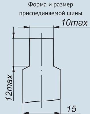
Зажимы допускают присоединение медных и алюминиевых проводников сечением от 2,5 до 50 мм<sup>2</sup>
