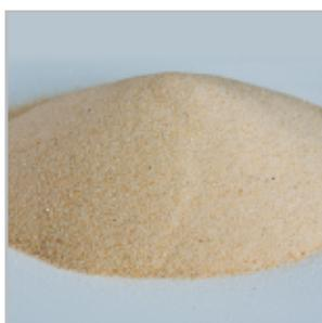
Технология засыпки предохранителей наполнителем (кварцевый песок высокой очистки) позволяет достичь высокой плотности заполнения и обеспечивает эффективное гашение электрической дуги внутри предохранителя при его срабатывании.
