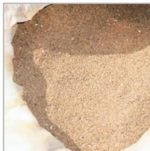
Наполнитель предохранителя, кварцевый песок высокой степени очистки, обеспечивает эффективное гашение электрической дуги внутри предохранителя при его срабатывании.
