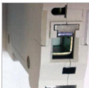
Насечки на контактных зажимах обеспечивают максимально плотный контакт, увеличивают механическую прочность соединения и снижают значение переходного сопротивления, тем самым гарантируют, что подключенные проводники не перегреются и не оплавятся.
