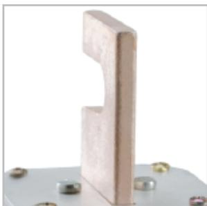
Выводы (контакты) предохранителя выполнены из электротехнической меди с гальваническим покрытием (серебрение), что обеспечивает высокие показатели токопроводности и долговечности эксплуатации.
