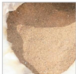
Наполнитель предохранителя, кварцевый песок высокой степени очистки, обеспечивает эффективное гашение электрической дуги внутри предохранителя при его срабатывании.
